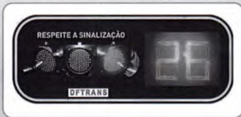
Grupo focal veicular de contador regressivo numerico digital em led's, modelo horizontal, podendo realizar a contagem regressiva também no tempo vermelho/verde, podendo ser fabricado em fibra de vidro, polietileno ou alumínio. integrado com três focos de led (200mm x 200mm x 200mm).
